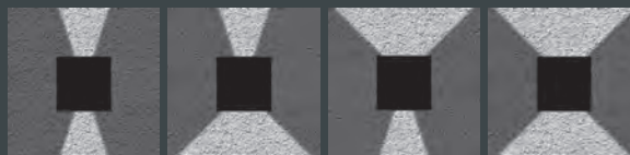
Варианты настроек угла светораспределения PWL-120120/0-90D
